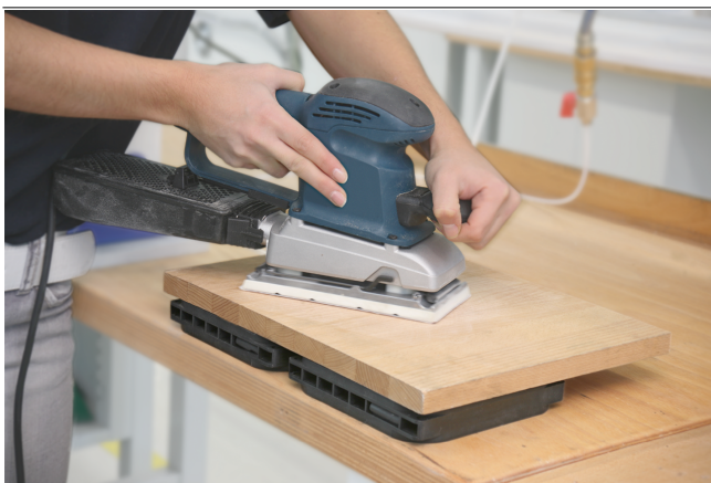
Multi-Clamp piastra di aspirazione VC-M-SP per la lavorazione manuale di un pezzo di legno
